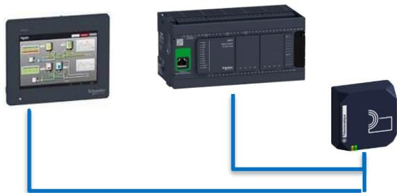
Smart antenna Modbus RTU integrato
